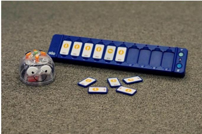
Befehlsabfolgen für den BlueBot gelegt werden können. Dadurch werden die Programmbefehle visualisiert. Der Tactile Reader verfügt über einen fix verbauten Akku, der via USB aufgeladen werden kann. Die Verbindung zum BlueBot-Roboter wird via Bluetooth hergestellt. Über den Tactile Reader können dieselben
